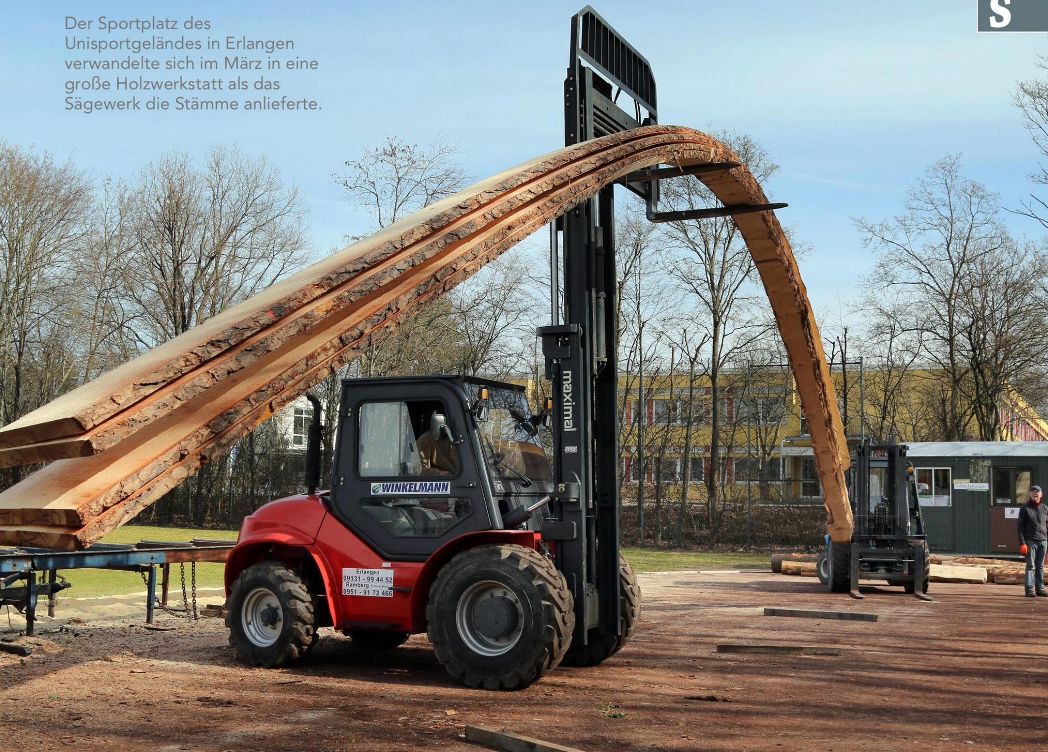
Ein spezialisiertes Unternehmen und freiwillige Helfer verarbeiteten insgesamt 20 Kiefern zu Spanten und Planken, dem Gerippe und der Außenhülle des Schiffes. Ein mobiles Sägewerk schnitt die Stämme in passende Bretter.
