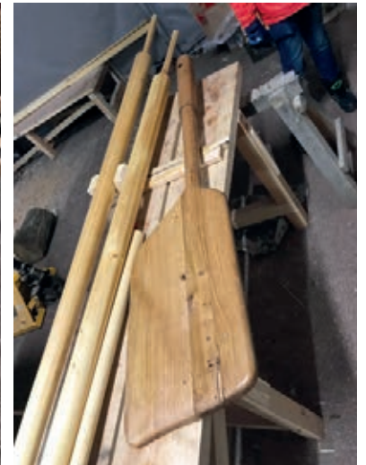
▲ Blick in die Werkstatt: verschieden lange Steuerruder wurden angefertigt. Das kurze Steuerruder kann auch bei niedrigen Wasserständen eingesetzt werden. Im Detailbild ist gut zu erkennen, dass das Ruder aus mehreren Teilen mittels Nut und Feder verbunden ist.
